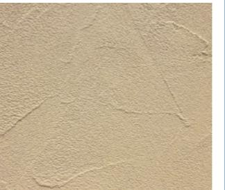
弾性アクリル系樹脂を結合材に用いた骨材配合の素材。コテ・吹付け・パターンローラーなどによる多彩な表現ができることで、近年人気を博している。色褪せがしにくく、耐候性に大変優れているが、下地の反りによるクラックや汚れなどの美観的な問題から13～15年程度で再塗装。
